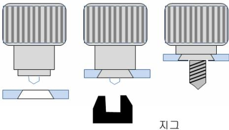
카운터싱킹으로 출가공된 모재에 캡티브볼트의 삽입부를대고 삽입부가 확장될수있도록 확장지그가 장착된 프레스를 눌러 삽입부가 모재의 카운터싱킹형상으로 모재의 출내부에서 퍼져서 확장됨으로써 영구고정되는 방식의 볼트
