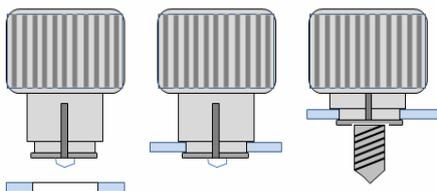
캡티브볼트의 삽입부가 홈으로 벌어져 있어 그 삽입부를 출가공된 모재에 대고 단순히 누르면 홈이 좁혀지면서 모재의 홈에 삽입된후 다시 원상태로 돌아와 고정되도록 하는 방식의 볼트
